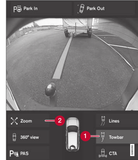
Tažné zařízení s naváděcími liniemi 124 .
