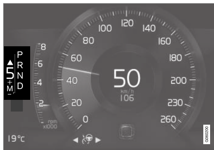
Indikátor řazení převodových stupňů na 8" displeji řidiče.
