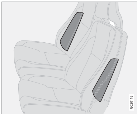
Umístění bočních airbagů.
